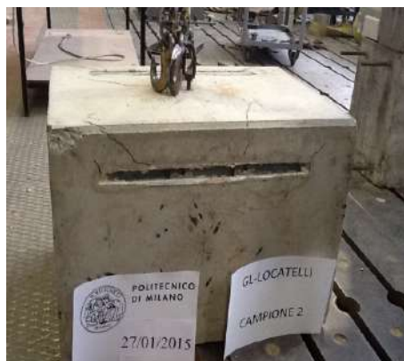
Prove eseguite presso i laboratori del Politecnico di Milano su profili di ancoraggio GP40/223 ETA-CE GP50/30 ETA-CE corredati di connettori H (M16)
