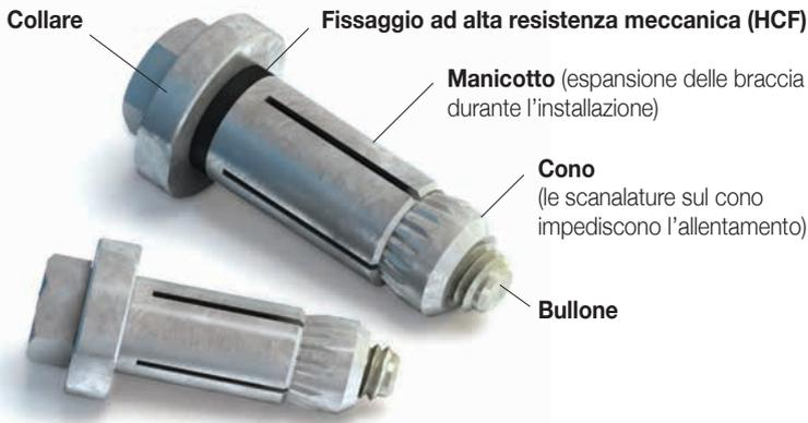
Adatto per profili cavi, tubi e nei casi in cui l'accesso al fissaggio è disponibile da un solo lato. Hollo-Bolt è un prodotto in continua evoluzione per soddisfare le richieste dell'Ingegneria Strutturale con prestazioni in continuo miglioramento incluso il brevetto di fissaggio ad alta resistenza (HCF). L'Hollo-Bolt è coperto da molteplici brevetti internazionali e modelli registrati.
