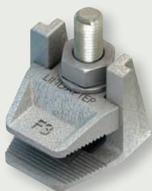
I Fissaggi di Supporto Lindapter sono molto apprezzati per il fissaggio delle tubazioni poiché consentono un'ampia regolazione rendendo facile l'installazione. In questo progetto il morsetto F3 è impiegato per collegare un tubo da Ø 100 mm che contiene cavi a fibre ottiche per internet ad alta velocità. Non sono state praticate né forature né saldature lungo tutto l'arco del ponte lungo 450 metri, simbolo di Manhattan.
